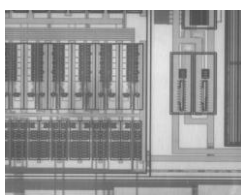
半導体ウエハ-赤外顕微鏡検査
