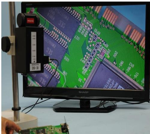
2K モニター表示 目視検査に最適
